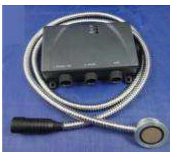
Il sensore è formato da un'unità elettronica e da un cavo con placca metallica di forma circolare. La placca viene fissata con pasta adesiva al di sotto del serbatoio (o dei serbatoi) o sull'esterno dell'involucro. L'unità elettronica è collegata via cavo al dispositivo di localizzazione GPS.
