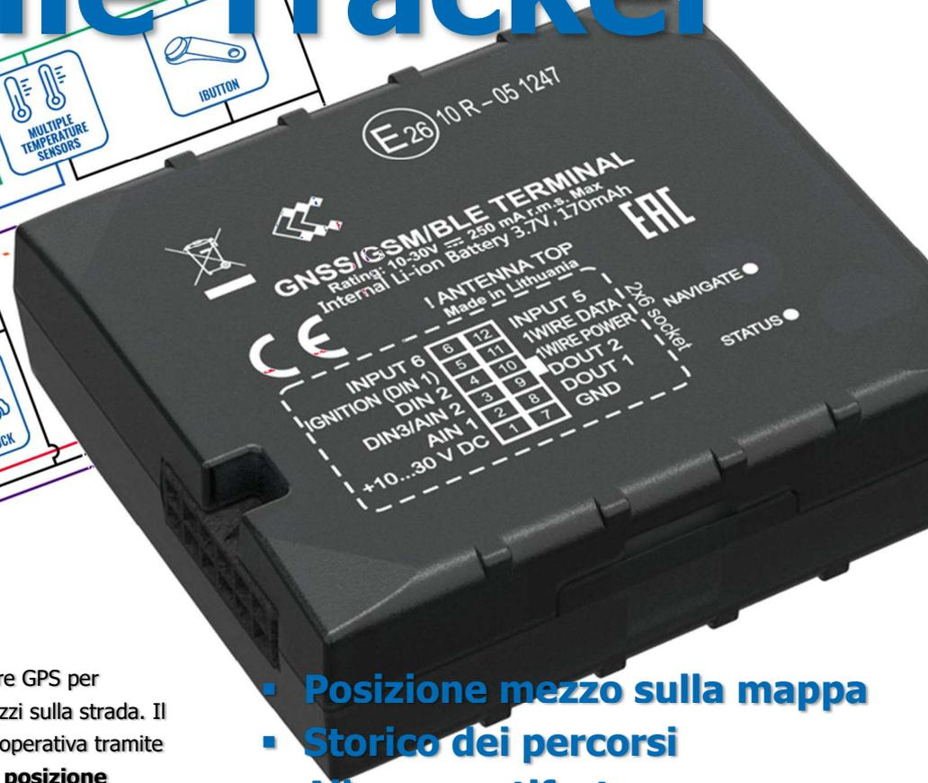
Mobile Tracker è un piccolo localizzatore GPS per semplificare e potenziare l'attività dei tuoi mezzi sulla strada. Il dispositivo è **sempre connesso** con la sede operativa tramite la rete cellulare. La sede conosce in diretta la **posizione geografica** del veicolo, può **vederlo muoversi sulla mappa** o sapere quale mezzo della flotta è più vicino al luogo di destinazione.
