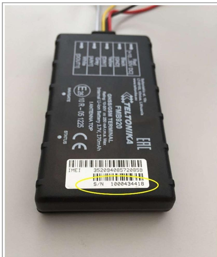
Figura 02. Identificazione del codice IMEI del localizzatore
